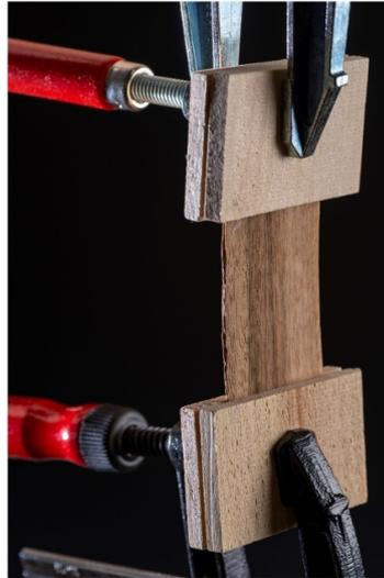
Abbildung 2: Zugbelastung eines Eichenfurnierstücks in Faserrichtung. Deutlich ist die Maserung des Holzes in Längsrichtung zu erkennen
