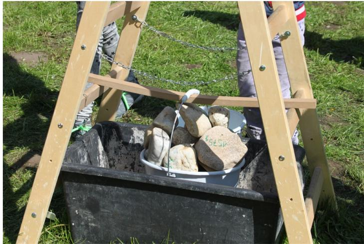
Abbildung 3: Aufbau für den Biegeversuch.
