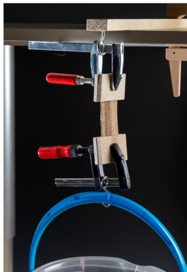
Abbildung 1: Versuchsaufbau zur Zugbelastung von Holz
