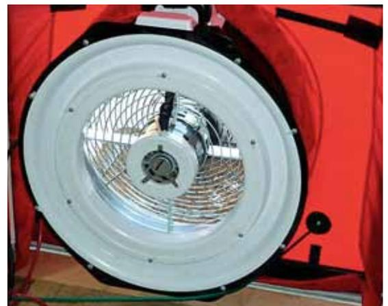
Abb. 4.1.1 Blower-Door-Messgerät
