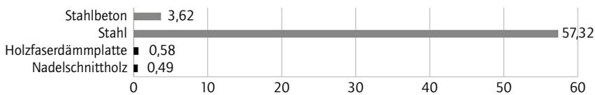
Diagramm 4.1.3 Temperaturleitfähigkeit verschiedener Materialien. Einheit: [m²/h], Quelle: ON-V31, Katalog f. wärmeschutztechnische Rechenwerte von Baustoffen und Bauteilen, Werte aus Zuschnitt 30: Holz bauen Energie sparen, proHolz Austria 2008
