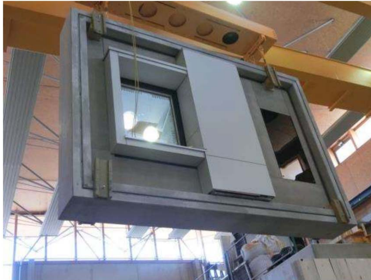
Abbildung 67: Einheben des gesamten Vorhangfassadenmoduls im Labor für Bauphysik der TU Graz (Bildquelle: TU Graz)
