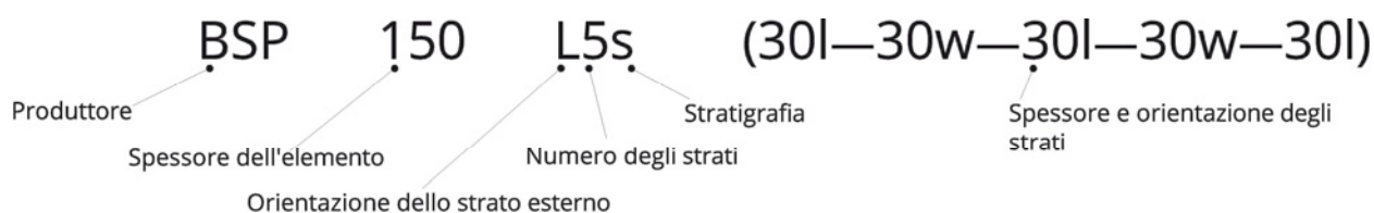
Figura 2-12: Descrizione della stratigrafia di un pannello XLAM
